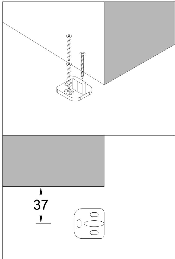
5. Installer le montant de finition B avec le montant de réception C puis le montant de finition B et la traverse de finition D comme indiqué sur les schémas à l'aide de colle. Pour assurer une plus grande stabilité du montant de réception, il est conseillé de fixer le montant de fintion B avec des vis et chevilles adaptées au type de mur (non-fournies).
