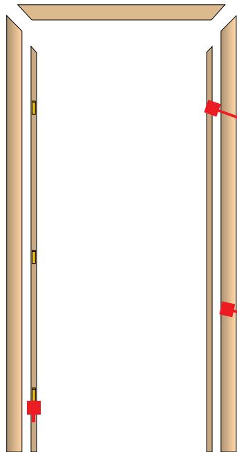
**CADRE** - Le cadre est réalisé en bois stratifié et recouvert de mélaminé, complété avec joint de feuillure, contre-plaque nickelée et ferré avec 3 charnières de type anuba.
