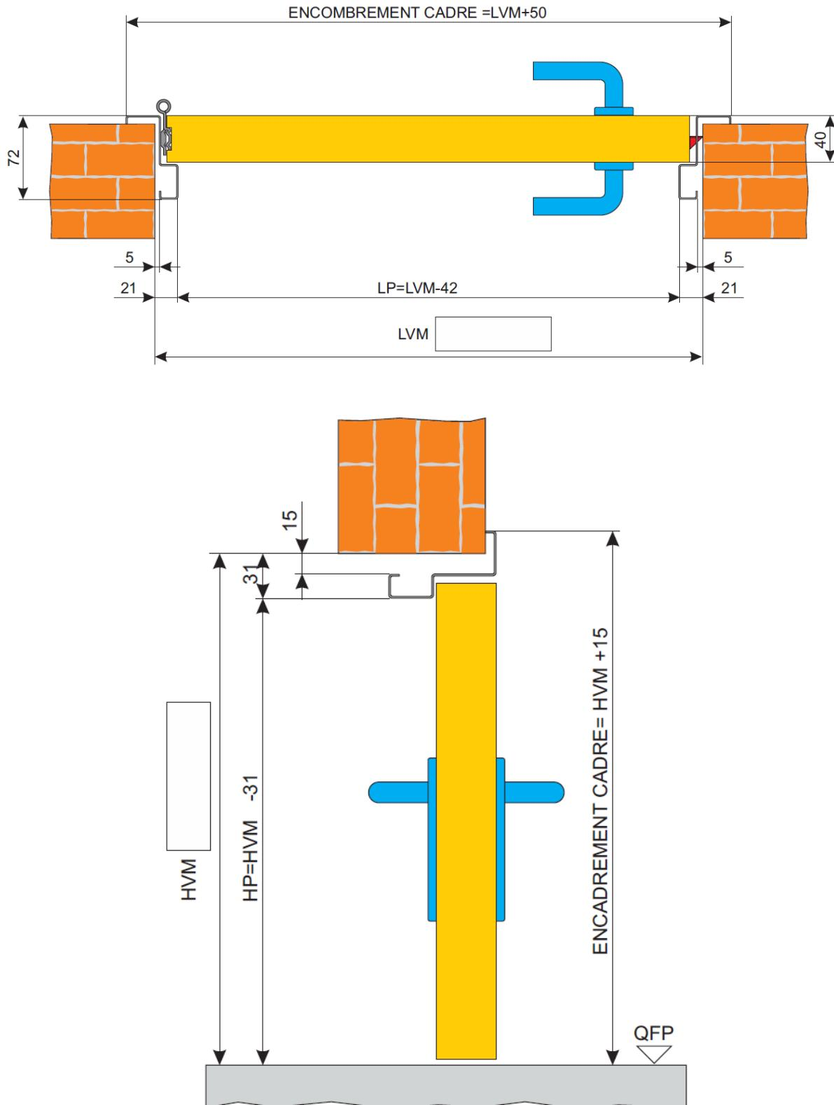
LVM : Largeur maçonnerie (côte de commande)
