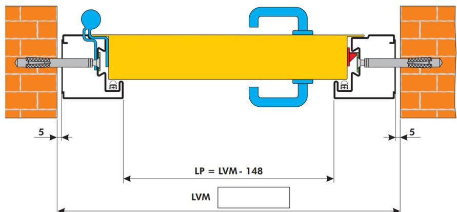
HVM = Hauteur de maçonnerie // LVM = Largeur de maçonnerie
