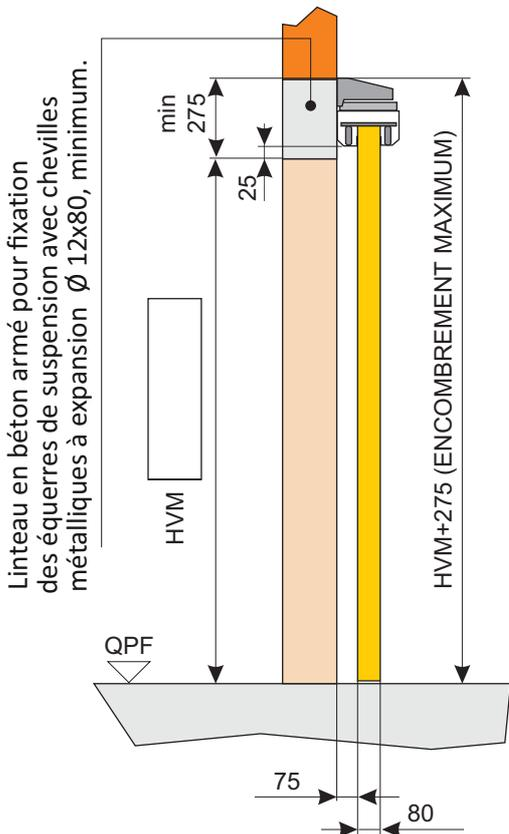
Linéau en béton armé pour fixation des équerres de suspension avec chevilles métalliques à expansion  $\varnothing 12 \times 80$ , minimum.
