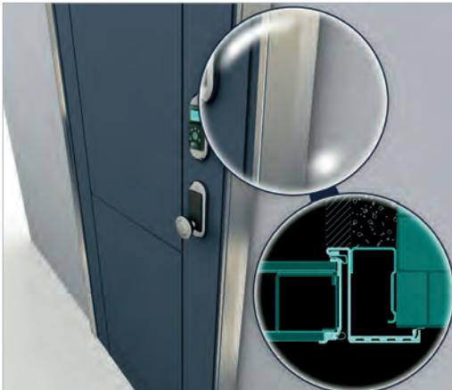
La pose type "Standard" se présente avec un cadre et un pré-cadre dédiés qui permettent une presque coplanarité avec le mur, (côté intérieur).
