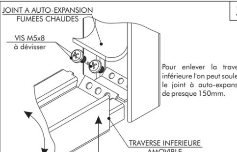
Dans le cas où la traverse inférieure ne serait pas utilisée et/ou créerait des obstacles, elle peut être enlevée en dévissant les 2 vis à droite et les 2 vis à gauche, comme dans la figure. La SPLIT avec ou sans traverse inférieure reste conforme et valable en termes de certification et homologation.
