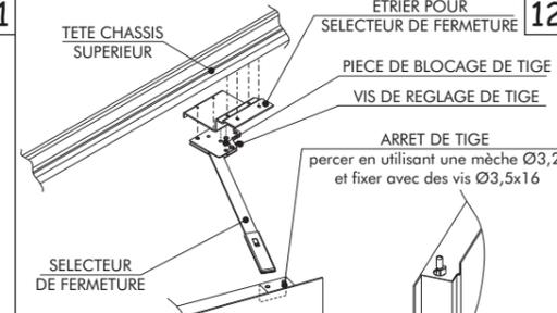
Le sélecteur, les étriers et les vis sont fournis dans un kit séparé. Visser l'étrier de support sélecteur à la tête supérieure du châssis. Ensuite, visser le sélecteur de l'étrier. Une fois la pose effectuée, éliminer la pièce de blocage de la tige.
