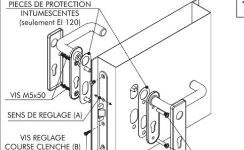
Monter les poignées et contrôler la fermeture correcte de la porte. Si l'ouverture du loquet nécessite trop d'effort, déplacez la serrure en suivant la flèche (A) et tournez la vis de réglage du loquet (B). N.B. La figure montre une serrure incendie et le réglage de la serrure.
