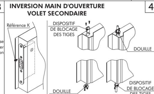
Vérifier que la vis (réf K.) placée sur la coque de la contre-serrure, se trouve toujours sur le supérieur par rapport à l'emplacement de la clenche. Faute de quoi, la déplacer. Démontez le dispositif de blocage de tige de la partie supérieure du volet secondaire et la douille de la partie inférieure. Remonter les deux pièces en les inversant.
