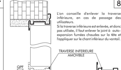
Après la pose et le réglage, la traverse inférieure au plancher peut être éliminée en dévissant les vis (fig. 3), en laissant inchangées certification et classe EI de référence.
