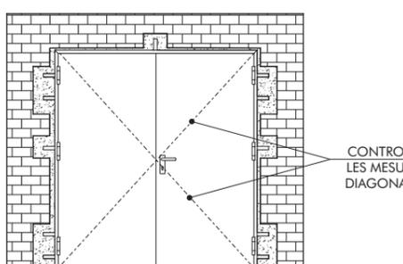
En utilisant des outils spécifiques, créer dans le mur les évidements pour le murage des agrafes. Plier les agrafes. Insérer la porte complète, ou le contre-châssis, dans le logement du mur, en respectant la hauteur du plancher fini. Pour garder la porte en position utiliser des coins en bois. Les placer en respectant le niveau du plancher, l'aplomb et les diagonales.
