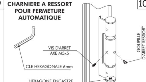
Charger le ressort dans le sens d'ouverture en utilisant la clé hexagonale 6 mm (au maximum 1/4 de tour), placer le cliquet d'arrêt dans le trou correspondant et bloquer le tout avec un grain de arrestation. Essayer la fermeture automatique minimum 45° d'ouverture. Si la porte ne se ferme pas, la porte a besoin d'un ferme-porte ou elle n'est pas correctement installée.
