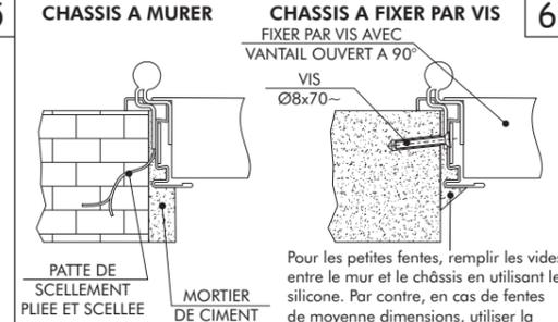
Murer les agrafes et le châssis, avec les volets montés, en utilisant du mortier de ciment à prise rapide. Si quelques évidements ne peuvent pas être réalisés, il est aussi possible de fixer le châssis au moyen de vis métalliques Ø8x70~ tamponnées. Une fois l'opération conclue, remplir les vides restés entre le châssis et la paroi avec du mortier de ciment.
