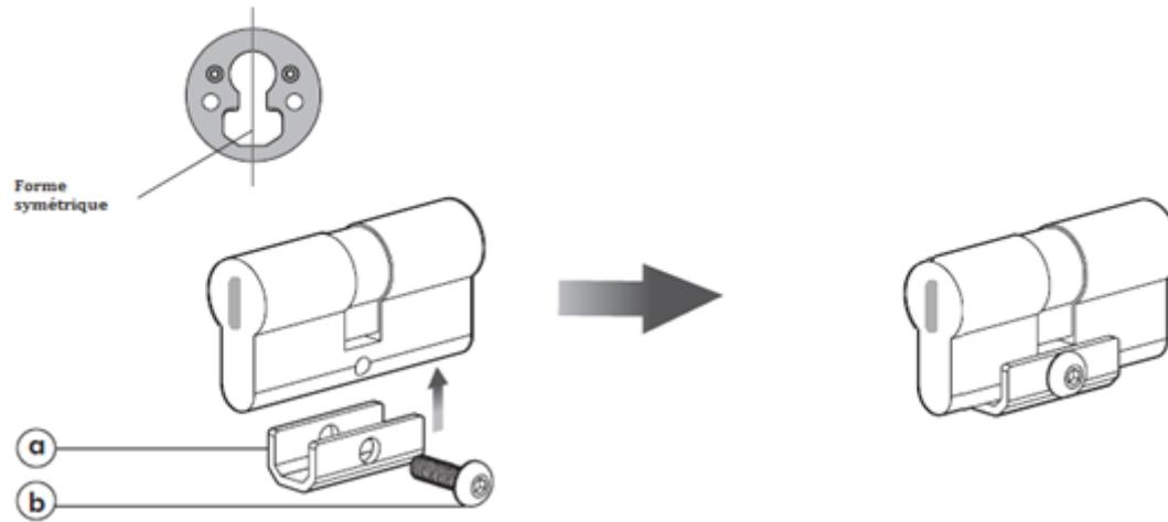
Retirer le cavalier du cylindre existant avec une clé allen 3 puis le remonter sur le nouveau cylindre.
