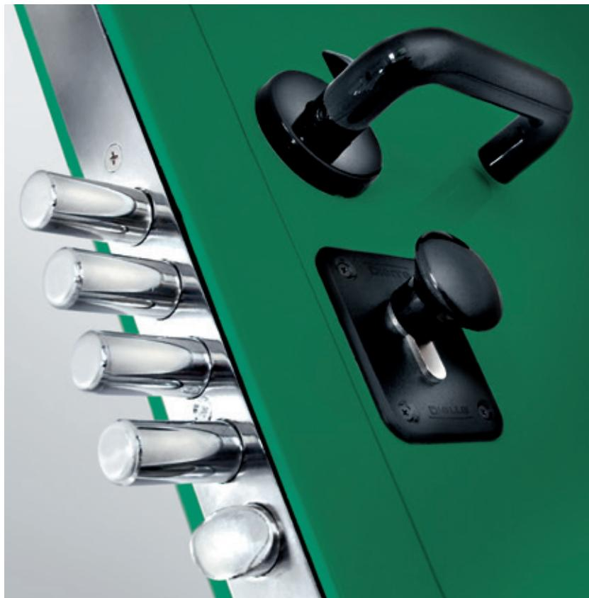
Les versions disponibles sont **UNDER 0** et **UNDER 1** avec une structure mono tôle et **UNDER 2** avec une structure double tôle. Le cadre existe en version Z ou tubulaire à visser. La serrure installée sur la porte permet de recevoir un cylindre européen de haute sécurité New Power ou en option une serrure à double panneton.
