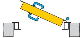
**DEFINIZIONE MISURA PORTA DA SEZIONE LONGITUDINALE**
