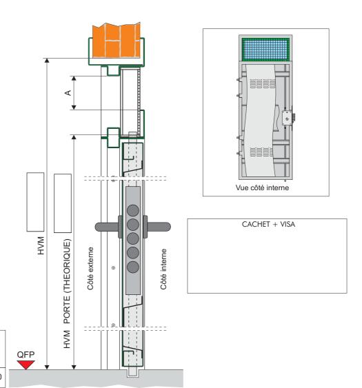
A = Passage Imposte HVM = Hauteur d'ouverture de mur LVM = Largeur d'ouverture de mur
