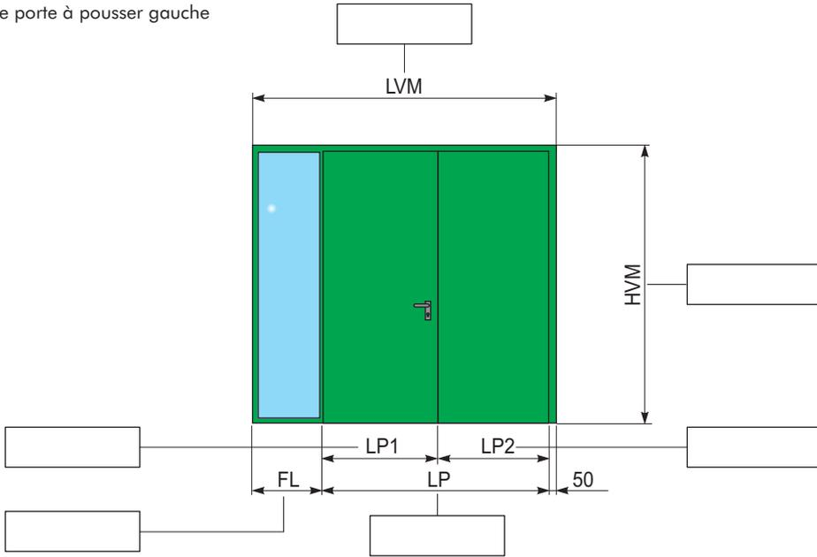
COD. VTb avec cadre tubulaire en "L"      COD. VTb avec cadre tubulaire en "Z"
