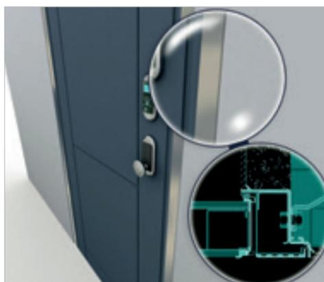
Le profil en aluminium "Top Secret" permet une mise en œuvre de la porte Wall Security complètement au raz du mur intérieur, (configuration porte à pousser). Du côté extérieur il est prévu que le cadre soit totalement intégré dans le mur.
